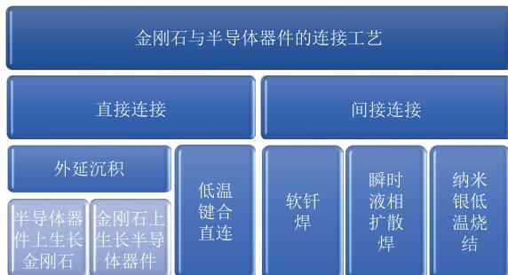
图 2 现有金刚石与半导体器件连接工艺的技术路线图
