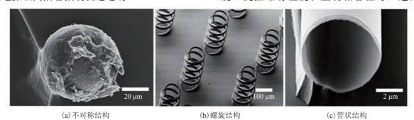
图 1 不同类型的微纳米机器人[7,11-12]
