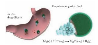
图 2 Mg-微型机器人治疗胃部细菌感染[31]
