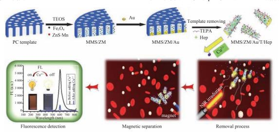
图 7 合成微型机器人并去除/检测血液中的  $Cu^{2+[43]}$
