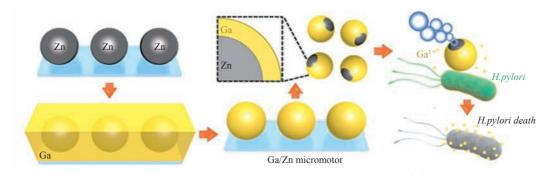
图 6 Ga/Zn Janus 微电机的制造和抗菌过程示意图[10]
