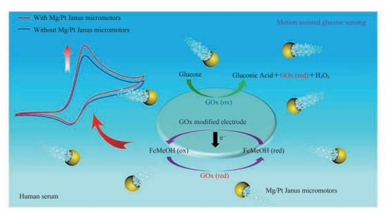
图 8 Mg/Pt Janus 微型机器人对人血清中葡萄糖的检测[45]
