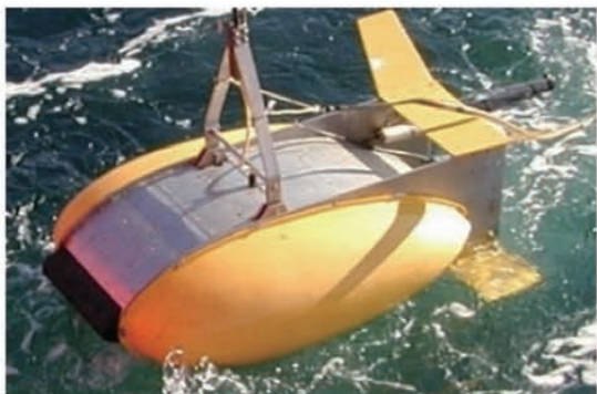
图 18 深拖电磁脉冲声源系统 (DTS boomer)
