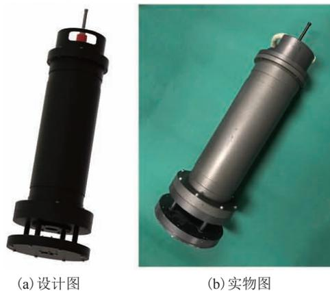
图 11 浮游生物成像仪设计图 (a) 与实物图 (b)
