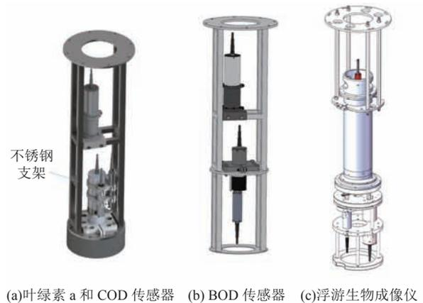
图 12 传感器与浮标平台集成框架示意图
