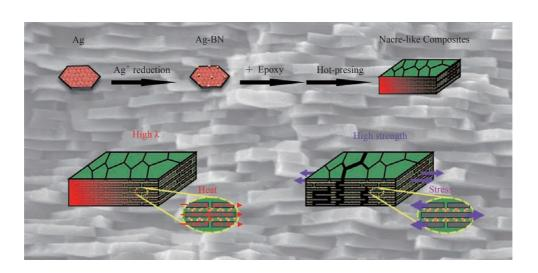
热压制备的 Ag-BN/ 环氧复合材料具有与天然贝壳相似微观结构,可兼具良好的导热性能与机械强度
