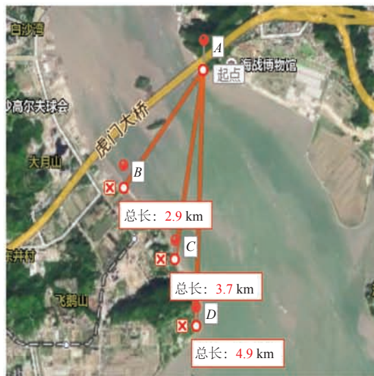
图 10 LoRa 通信距离测试图
