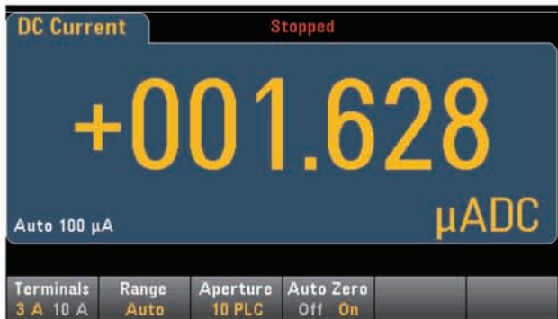
图 4 静态功耗测试结果
